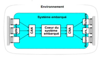
FIGURE 1.3 – Structure de base d'un système embarqué dans son environnement [46]
