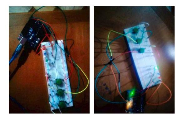
FIGURE 3.14 – Le résultat de programme du feu tricolore sur la carte Arduino
