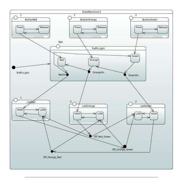
FIGURE 3.11 – Diagramme d'état transition du feu tricolore
