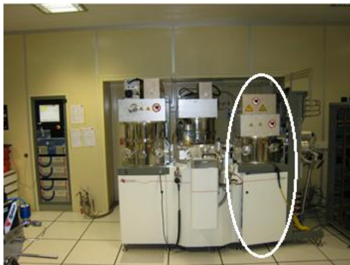
Figure IV.1. Photographie du bâti de dépôt Alliance Concept CT200 (IEMN).
