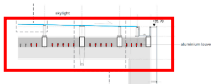
Figure 67 : Détails technique des persiennes en aluminium
