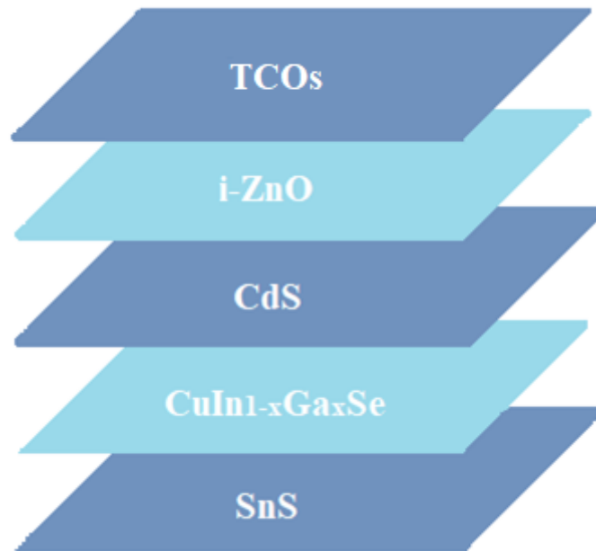
Figure III-1 : La structure de la cellule photovoltaïque TCO/i-ZnO/CdS/ \text{CuIn}_{1-x}\text{Ga}_x\text{Se} /BSF.
