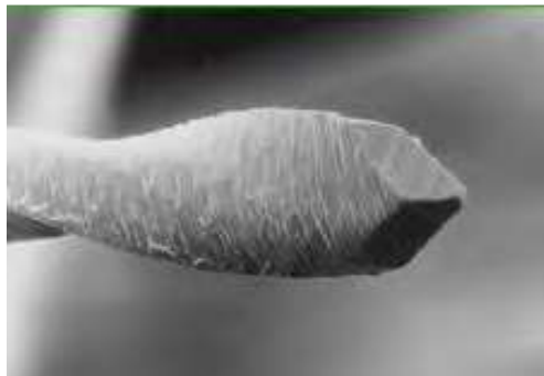
Figure 55 Pointe active du Mtwo® R en MEB (10) .
