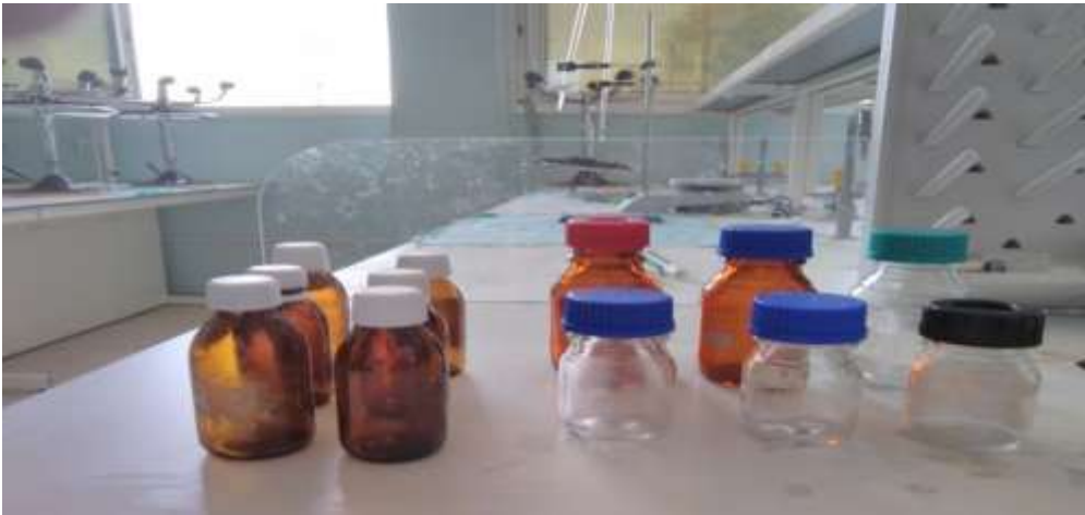
Figure 16: Flacons en verre borosilicaté capacité 100ml et 250ml
