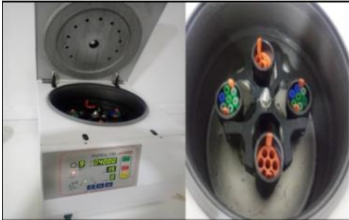
Figure18 : Une centrifugeuse Human HuMax 14K®.
