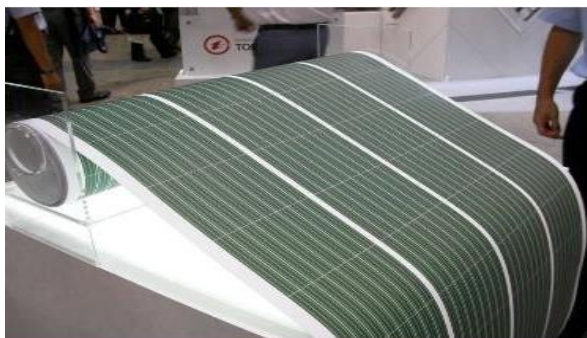
Figure I.7 : Cellule solaire de 2 ème génération [17].
