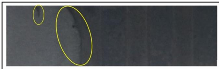
Figure 2.7 : Défauts d'impression par Slot Die sur substrat court [23]
