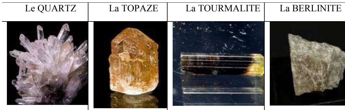
Fig. II.3 : quelques matériaux piézoélectriques [2]
