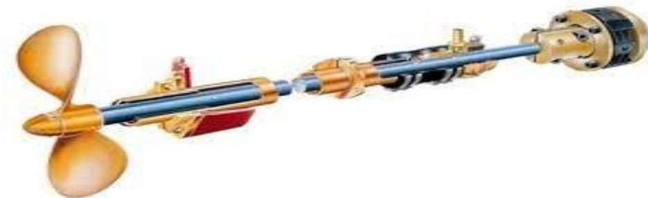
**Figure 1.2** Arbre d'hélice de bateau (S2.2020).
