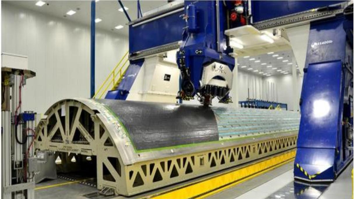
**Figure 2.6** Machine automatisée de placement de fibre (AFP). [S14.2020]
