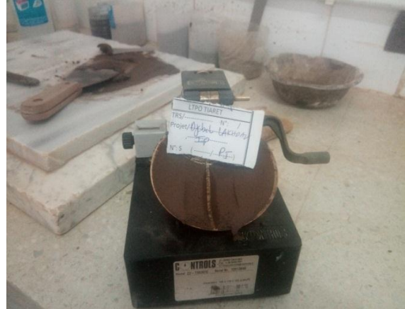
الصورة رقم 31: وضع العجينة في جهاز كازا جراند
