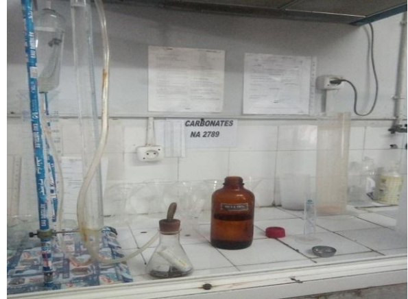
الصورة رقم 39: جهاز تحليل نسبة الكربونات في التربة
