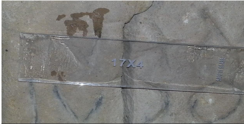
الصورة رقم 80: اختبار الشقوق المتحركة والثابتة
