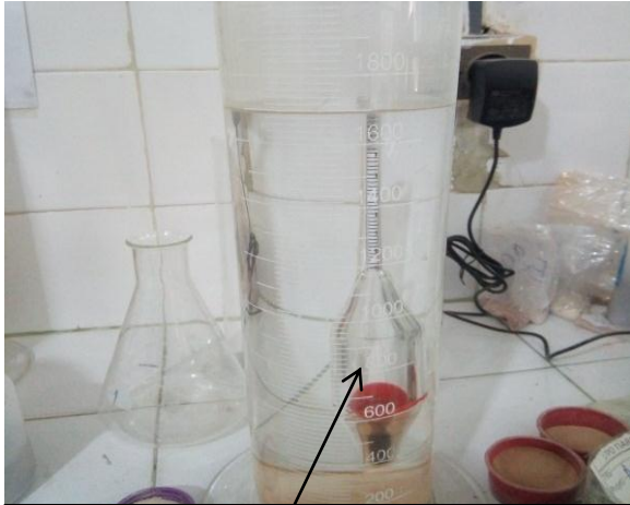
الصورة رقم 36: جهاز densimètre
