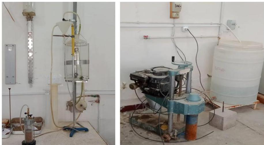
**Figure 3.25: Essai de perméabilité à charge constante (photo prise par HAMDIS. et BENSAFIA.)**
