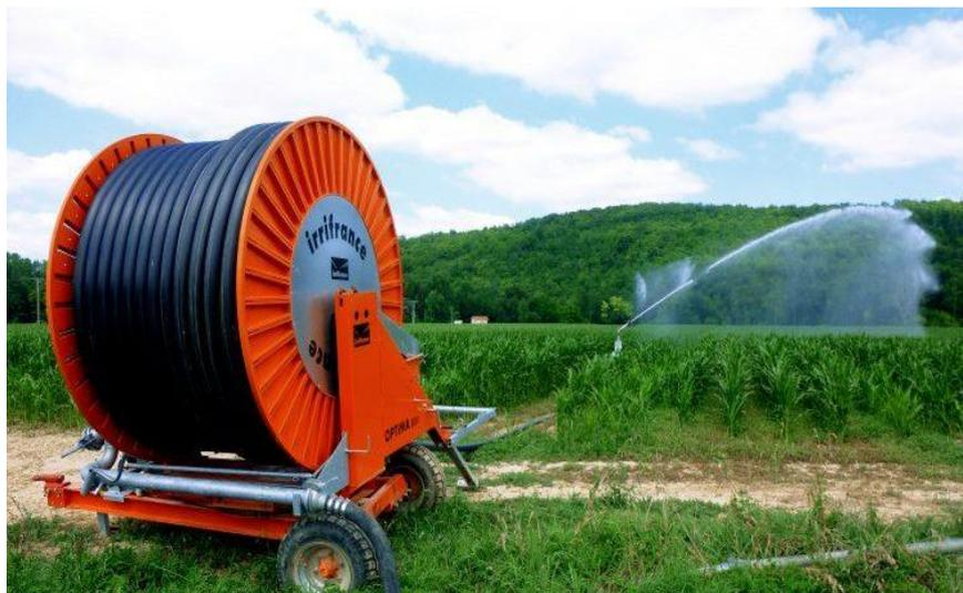
**Figure 2.16 : Irrigation par Enrouleurs**
