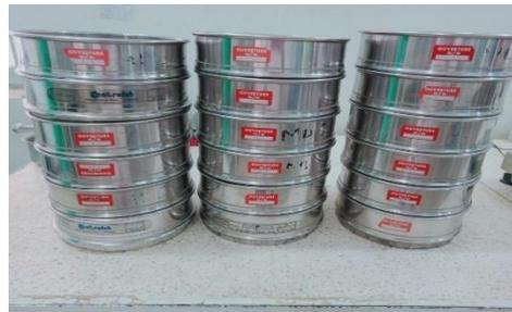
**Figure 3.19 : une batterie de 18 tamis (photo prise par HAMDLS et BENSALIA.)**
