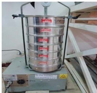
**Figure 3.20: le vibrotamis électrique (photo prise par HAMDLS et BENSALIA.)**
