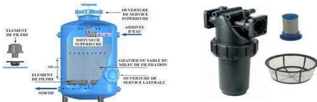
**Figure 2.9 : filtration à sable et à tamis**
