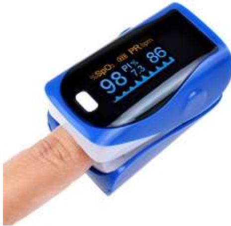
Figure II-4-4: Oxymètre de pouls,. Il permet la mesure de la fréquence cardiaque et la saturation en oxygène à travers la mesure des signaux PPG.
