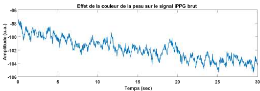
Figure III-5-2 : Mesure du signal iPPG à partir d'une peau foncée. Une dégradation de la qualité du signal est observable quand la couleur de la peau tend vers le noir.
