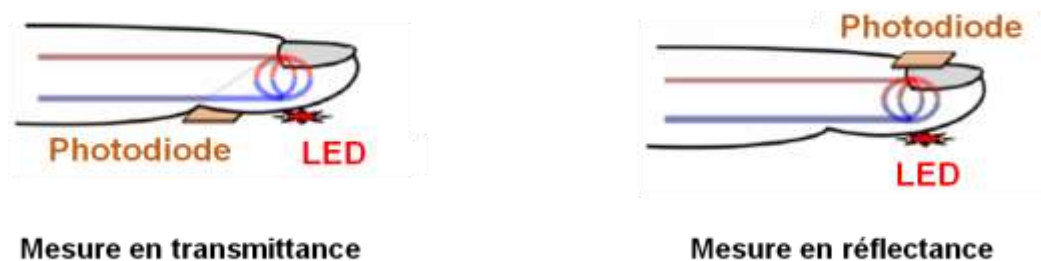
Figure II-4-1: Les deux modes utilisés en photopléthysmographie en contact
