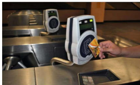
Figure III.4 : Lecture RFID pour le control d'accès [2].
