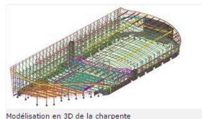
**Figure 61 : Modélisation en 3D de la charpente**
