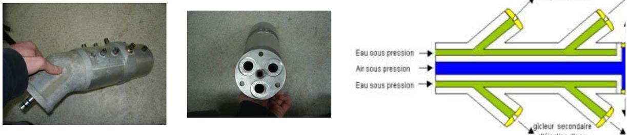
Différents orifices du canon à mélange externe | entrées d'air (centre) et d'eau (trous latéraux) sur un canon bi fluide à | Schéma de fonctionnement d'un canon à neige bi fluide à mélange externe
