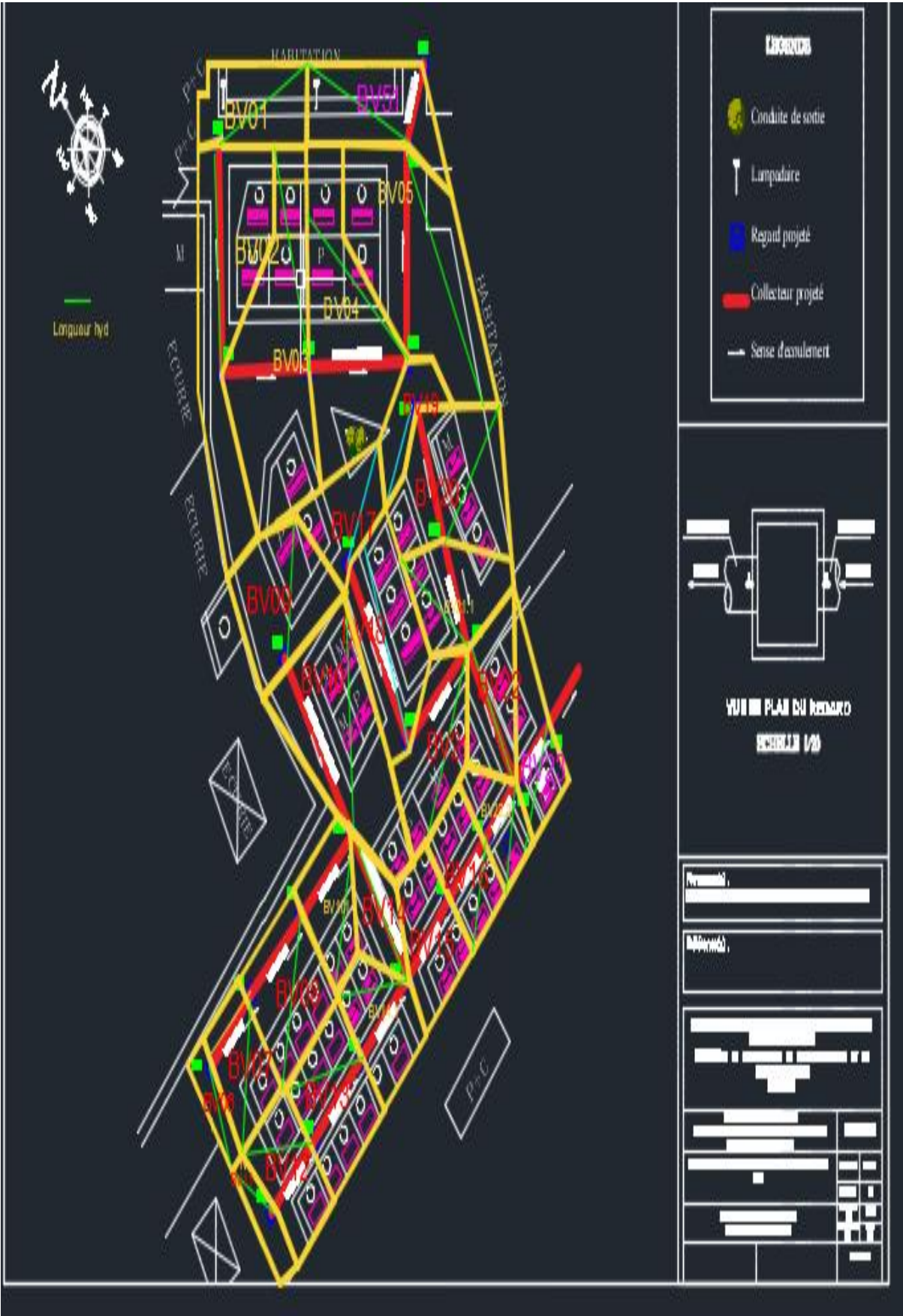
Figure III.3 : décomposition des sous bassins sur AutoCAD
