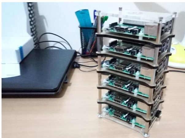
Figure 1.2: Cluster de 6 Pi3 qui émuleront des parties de microcentrales distribuées.
