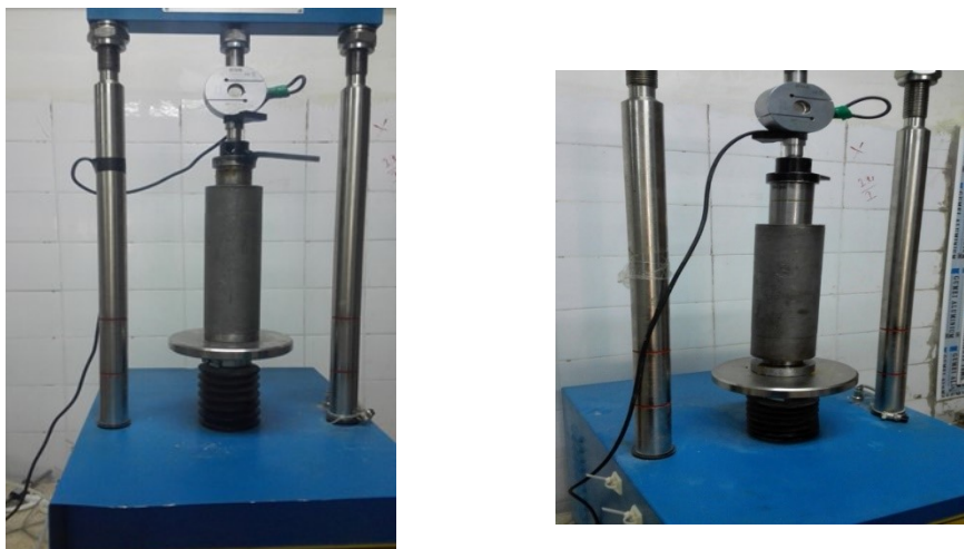
Figure 3.19 : Essais de compactage statique
