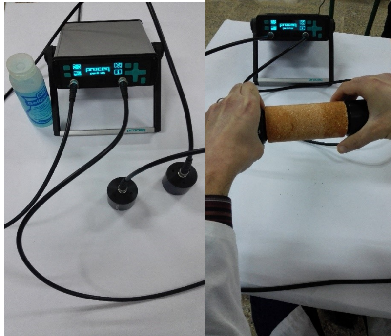
Figure 3.11 : Utilisation de l'appareil ultrason pour la mesure du module de Young
