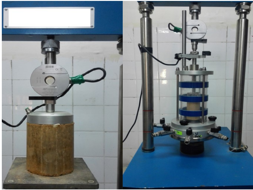
Figure 3.9 : Mesure de la résistance à la compression : a : échantillon compacté dynamiquement ; b : échantillon compacté statiquement
