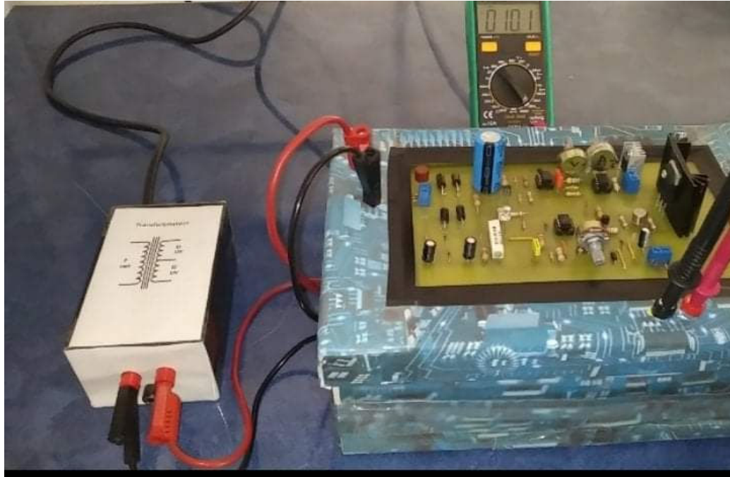
Figure III-5 : Tension de sortie ajustée à 10V de notre alimentation continue régulée que nous avons réalisée.
