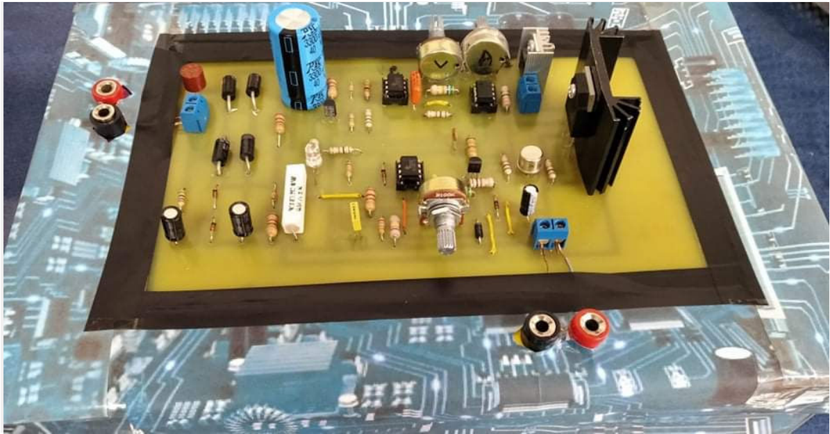
Figure III-4 : Photo du circuit imprimé de notre alimentation continue régulée variable et à fort courant que nous avons réalisée.
