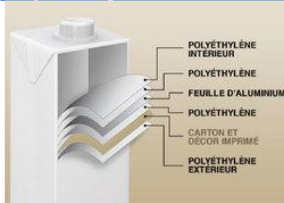
Figure I.11: fabrication des briques alimentaires Tetra Pak. (34)
