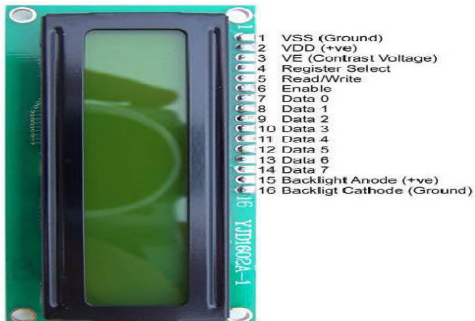
Figure 3.12 Description de L'afficheur LCD 16 x 2
