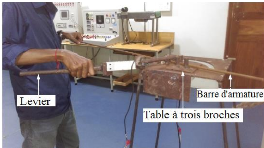
Figure 1.12. . Processus de cintrage des barres d'armature dans une configuration expérimentale
