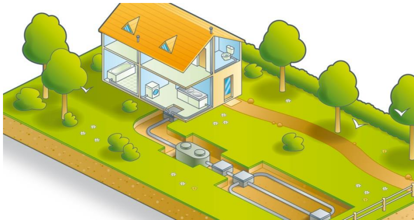
Figure I.2 : Types d'installation d'assainissement non collectif [4]
