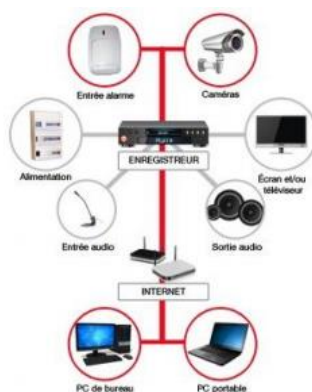
Figure 98 système de surveillance. Source : Google image
