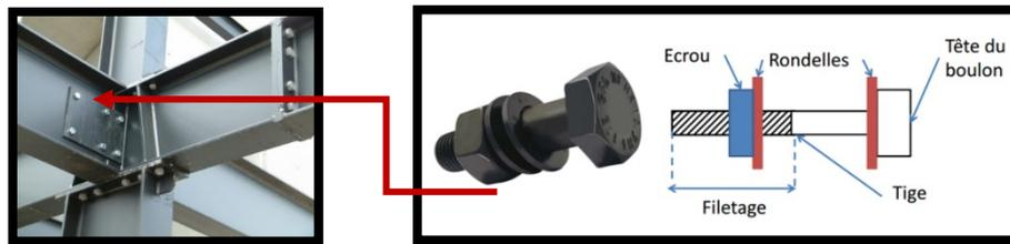
**Figure 74 :** Système de boulonnage comme moyen d'assemblage de la structure
