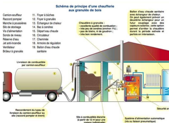
Figure 95. Fonctionnement de la chaudière biomasse (Chaleur eco).
