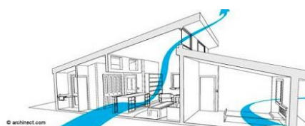
Figure 96. Ventilation naturelle système A (Eti-construction, 2016).
