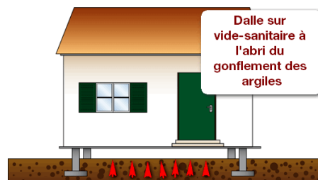
Figure 80. Dallage sur vide sanitaire (Lafond, s.d.)
