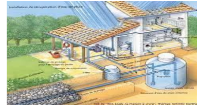
Figure 23 : récupération des eaux pluviales, source : la réutilisation des eaux pluviales ,Perraud Audrey,2005
