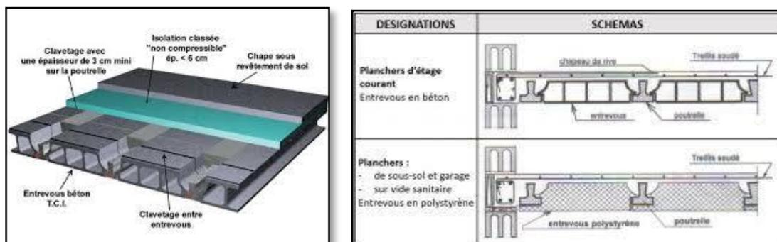
Figure 97.détails planchers hourdis<sup>129</sup>
