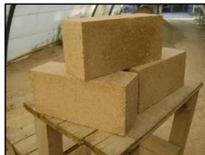
**Figure172.**Béton de terre stabilisé
