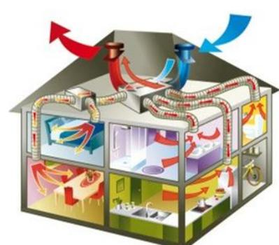
**Figure6.** VMC double flux.
