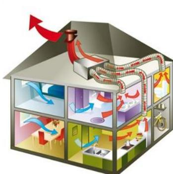
**Figure5.** VMC simple flux.
