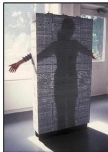
**Figure170.**Mur en béton translucide.
