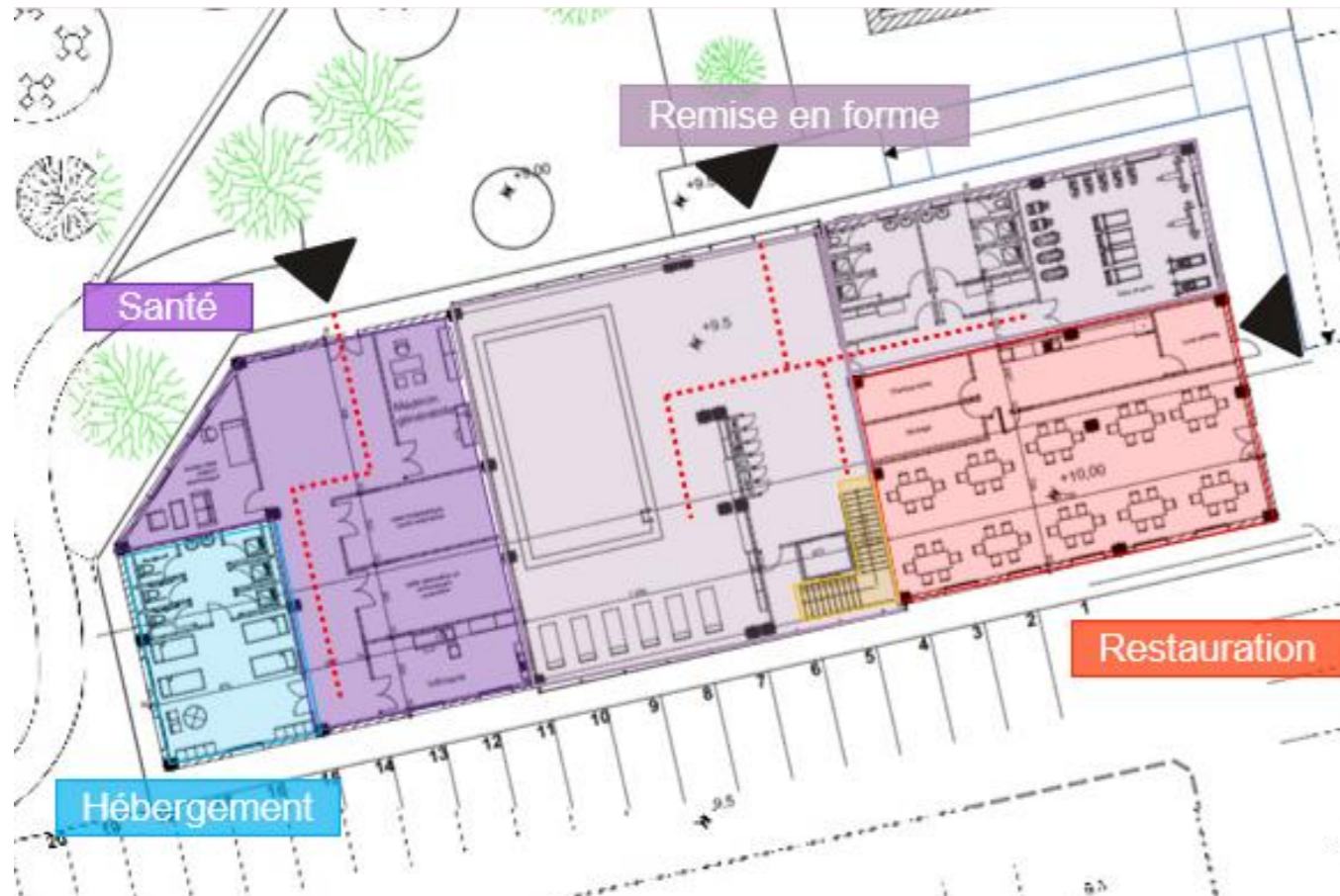
Figure 158. Plan du rez-de-chaussée – Bâtiment commun
