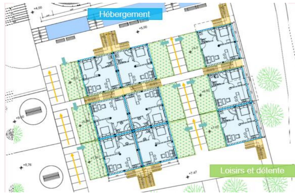
Figure 154. Plan du rez-de-chaussée – les appartements
