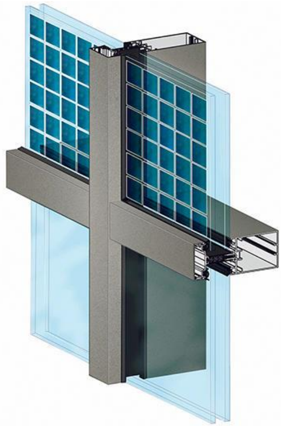
Figure 135: panneau photovoltaïque dans le mur rideau / source : google image.
