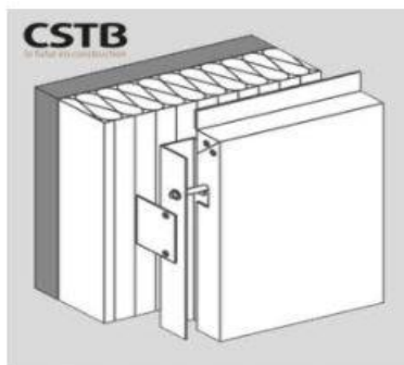
Cassettes accrochées sur un axe boulonné pour une disposition de panneaux verticale
