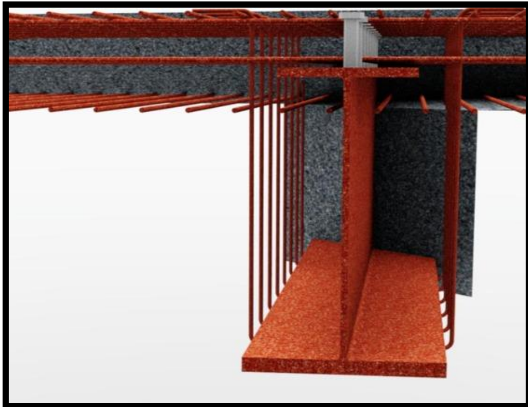
Figure 94: poutre-plancher / source : google image
