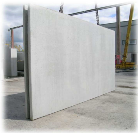
Figure 5 : pré murs en béton
