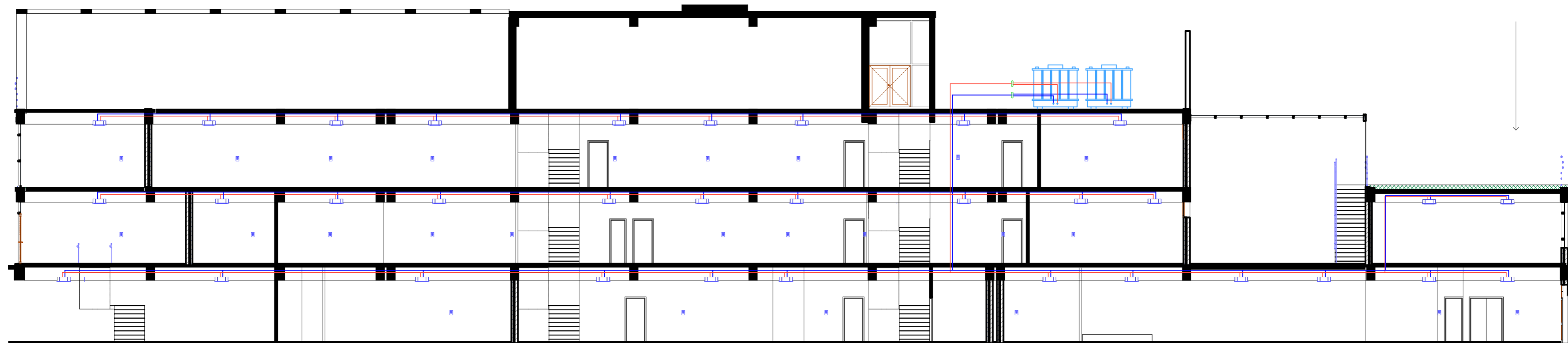
Coupe schématique du système de climatisation
