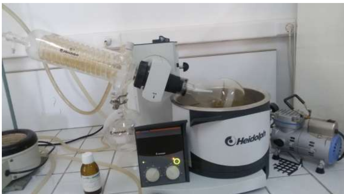
Figure 8 : Photographie du Rotavapor utilisé.
