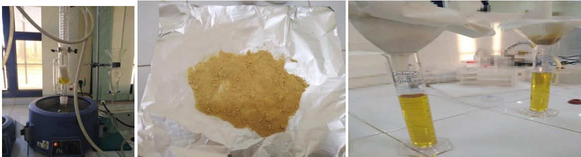
Figure n°13: Délipidation, séchage et filtration de la poudre dégraissée.
