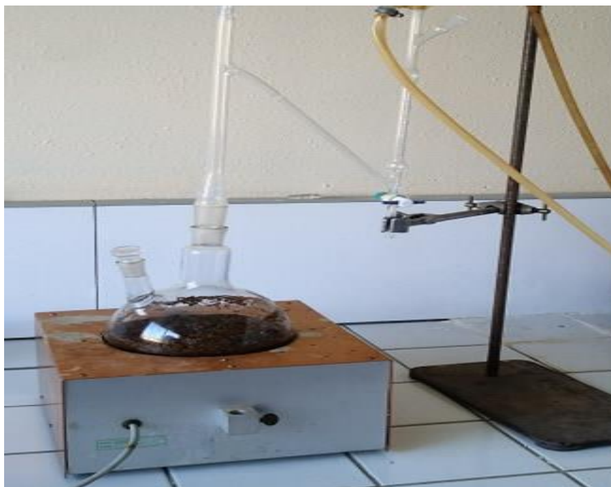
Figure 12 : Appareil d'hydrodistillation type « Clevenger »
