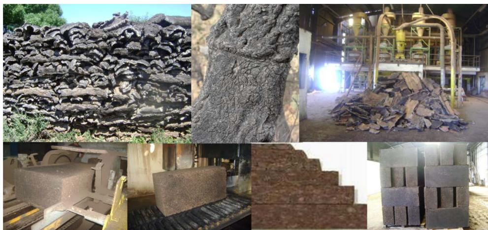
**Figure 8:** Le liège flambé et la fabrication des panneaux d'isolation à JLE de Jijel
