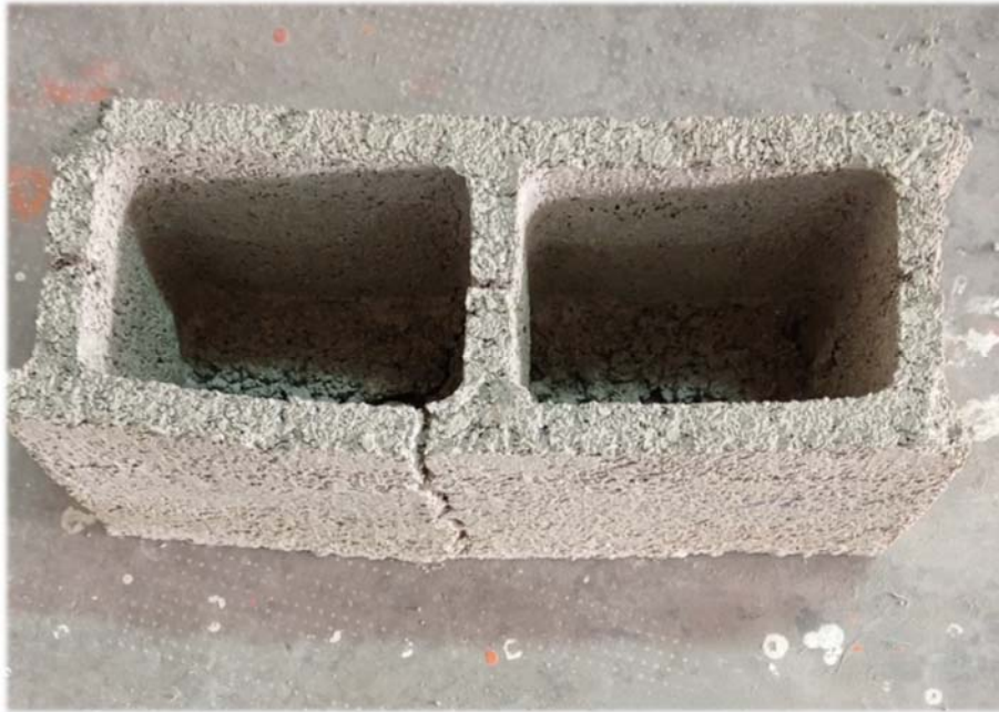
Figure 3-20: Fissure de rupture du bloc
