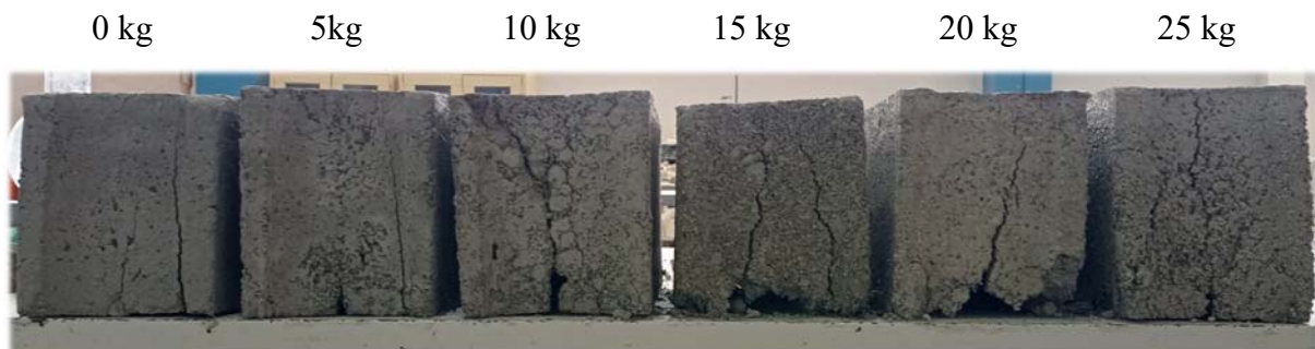
Figure 3-19: Blocs après l'essai de compression
