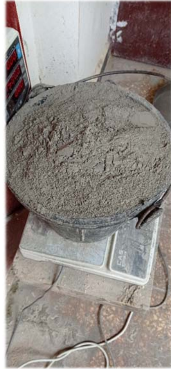
Figure 3-4: La pesée du ciment
