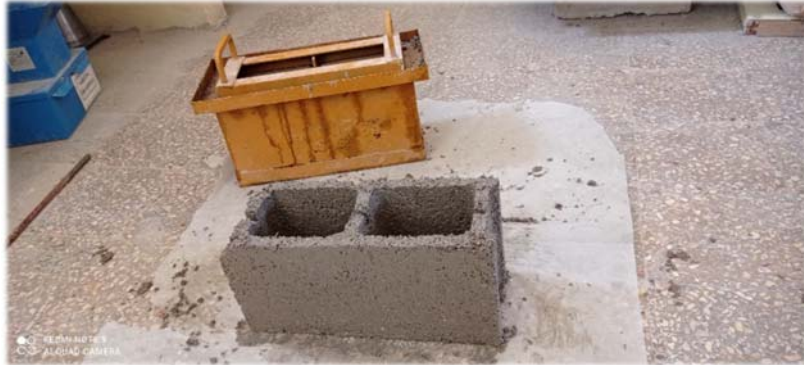
Figure 3-8: Bloc de béton de bois confectionné avec le moule manuel
