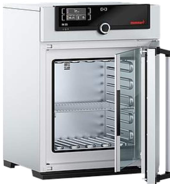
Figure IV.5 : Photo de l'incubateur bactériologie IN55-Memmert
