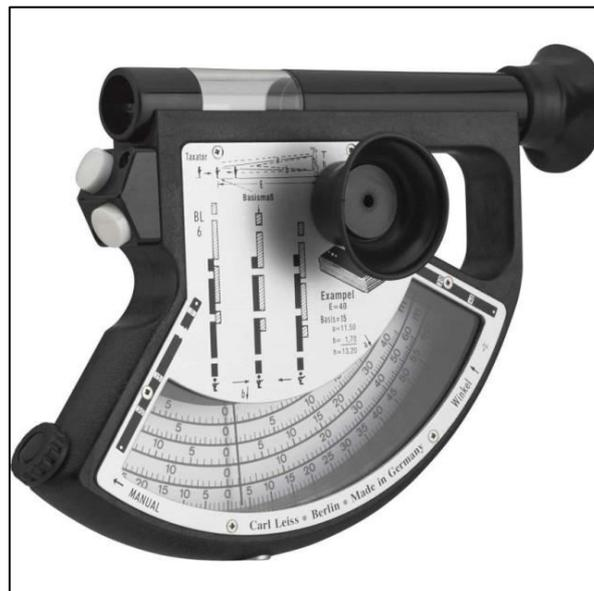
Fig. 22 : Le dendromètre Blum leiss (Rondeux, 1993).
