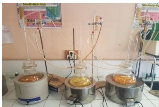
Figure .4.3. Montage d'hydrodistillation type Clevenger.
