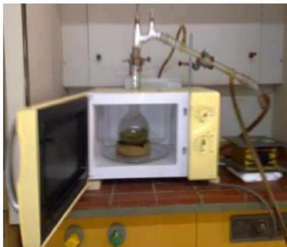
Figure .4 .7. Montage d'extraction assistée par microonde sous vide pulsé.
