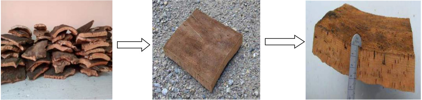
Figure 30 : Calas de liège avant et après raclage de la partie carbonisée et Mesure de l'épaisseur d'un échantillon grâce à un pied coulisse.
