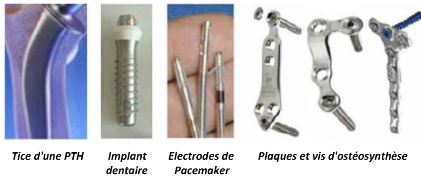
Figure 3.30 : Tige d'une PTH. implant dentaire et électrodes de pacemaker en titane, plaques d'ostéosynthèse en Inox-316L. et vis en Ti-6Al-4V
