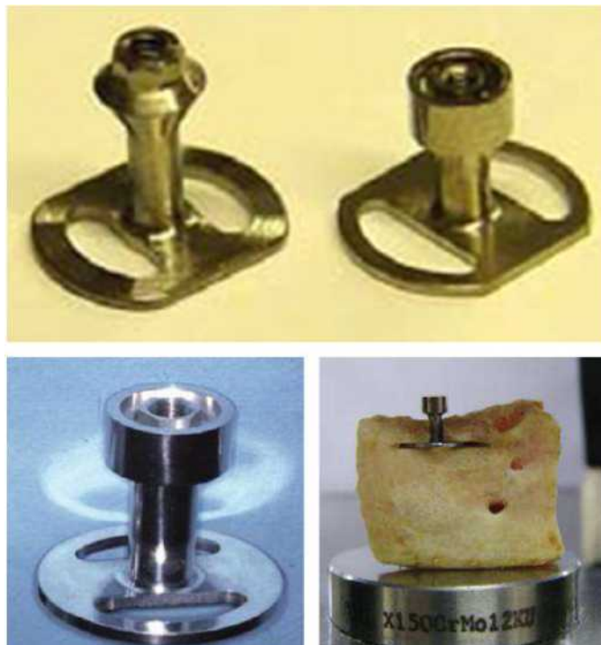
Figure 3.11 : Implants dentaires endo-osseux à insertion latérale [3]
