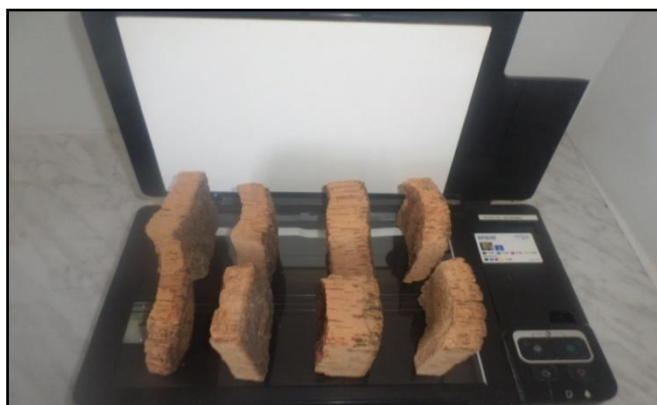
Figure 34: Acquisition de l'image numérique par scannage des échantillons (Belharizi, 2020)
