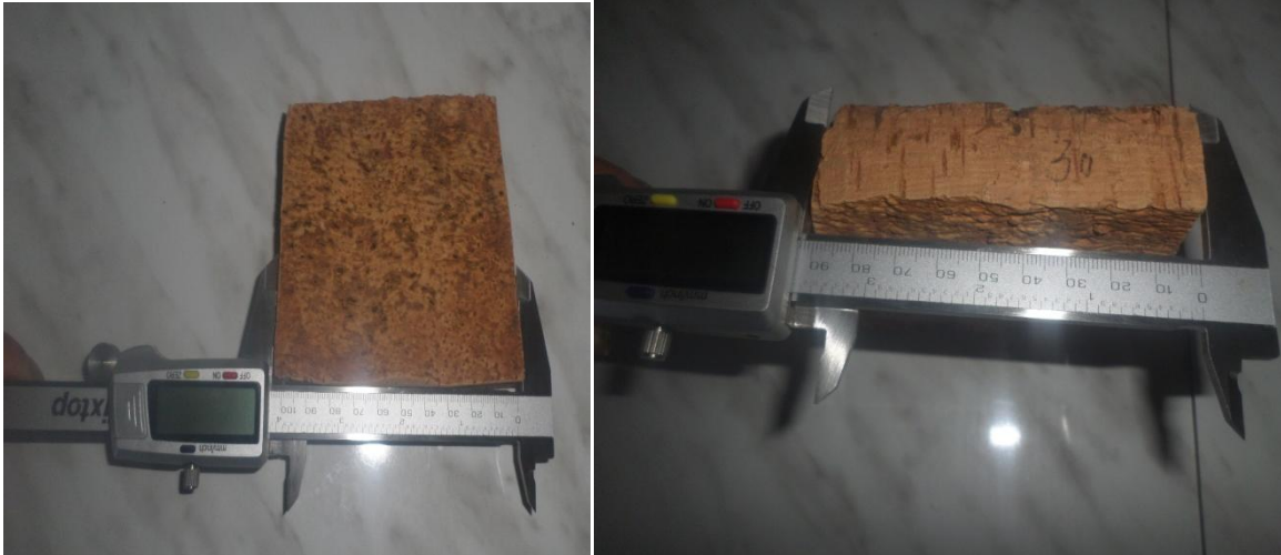
Figure31: Mesure des longueurs et des largeurs des échantillons (Belharizi, 2020)
