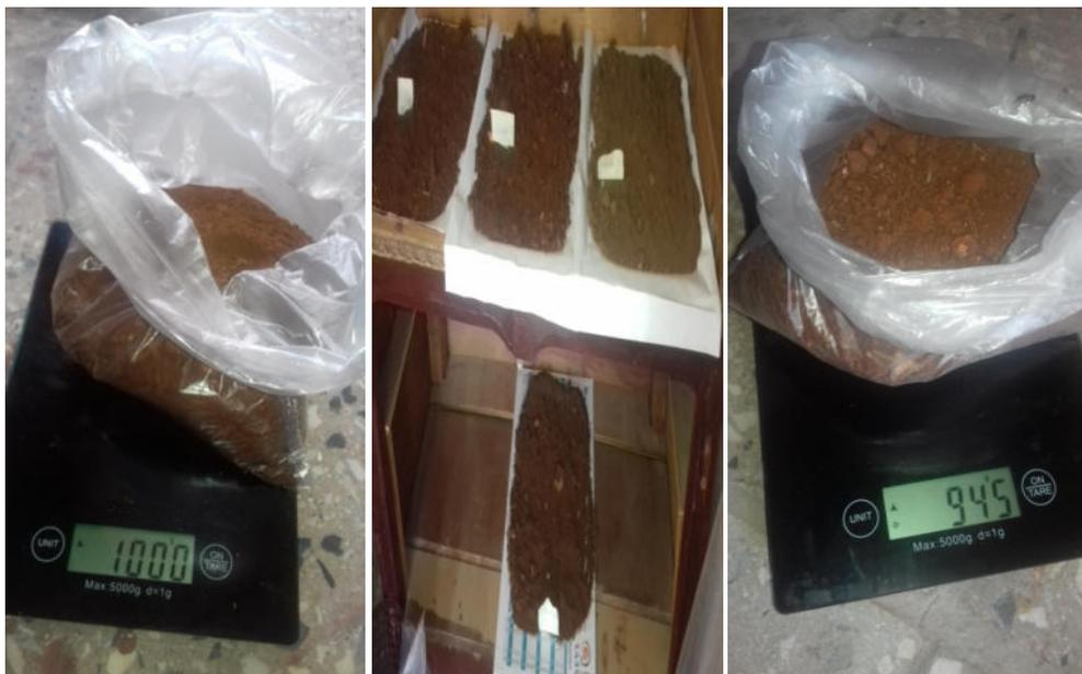
Figure N° 13 : Mesure de l'humidité de sol (Original).
