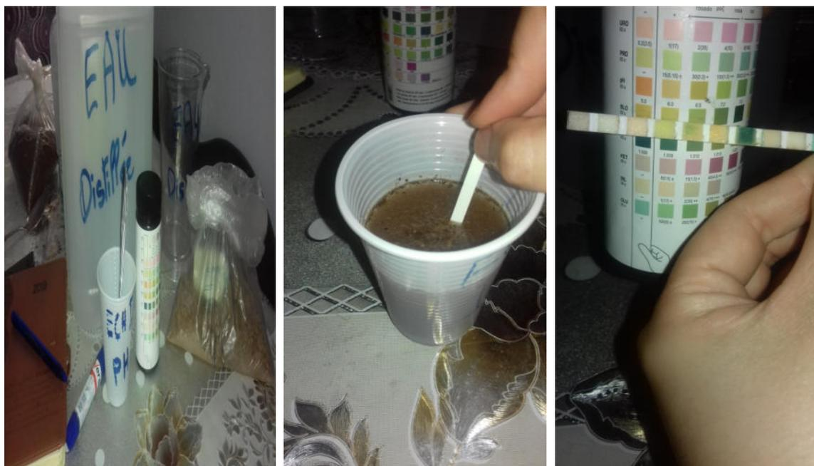
**Figure N°15 : préparations des échantillons pour les mesures de pH (Original).**
