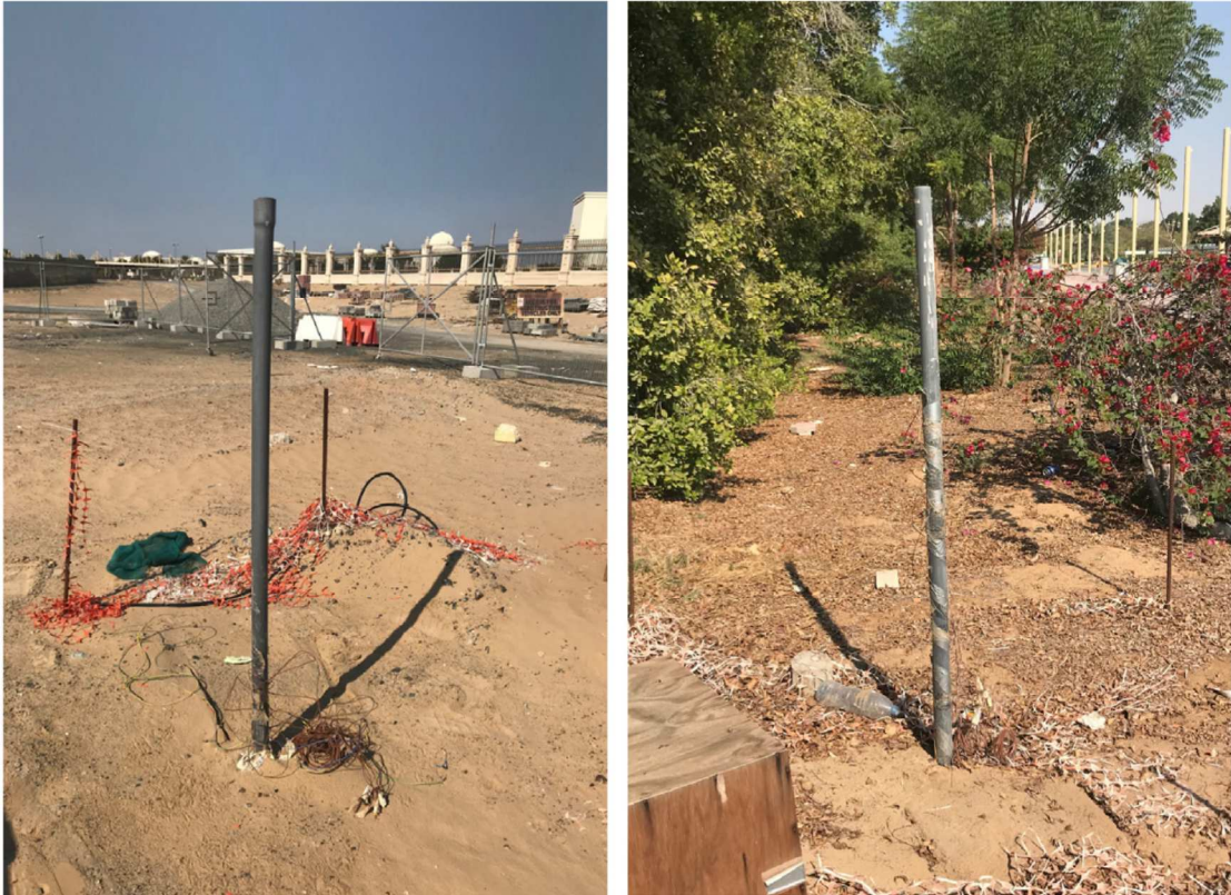
Figure (2.13) : Installation d'un forage sous a) le soleil direct en tout temps dans une zone sablonneuse non irriguée (BH-1) et b) une zone irriguée semi-ombragée près de plusieurs arbres [22]
