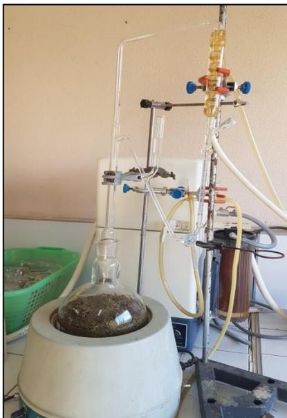
**Photo 3 : Dispositif d'extraction des huiles essentielles par hydrodistillation avec un appareil de type Clevenger**
