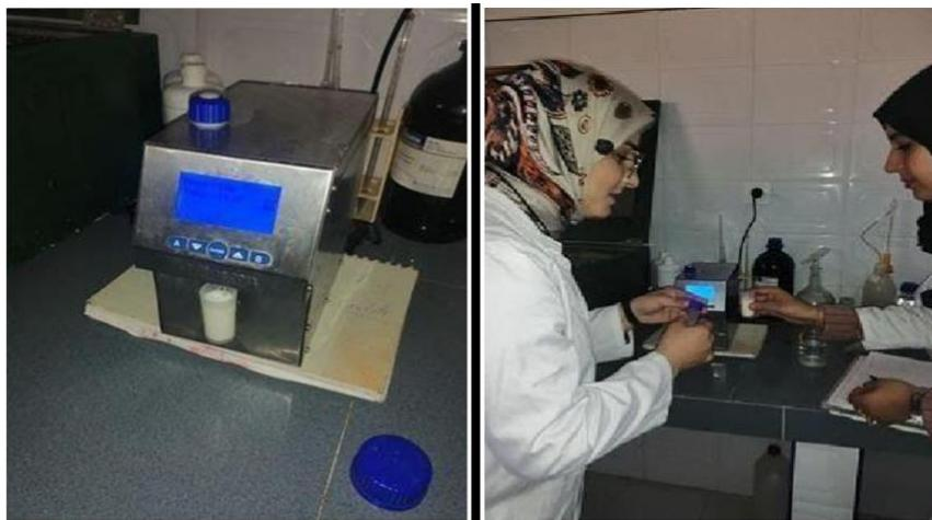
**Figure 16 :** Analyseur automatique **LACTOSCAN Milk Analyzer** de lait.
