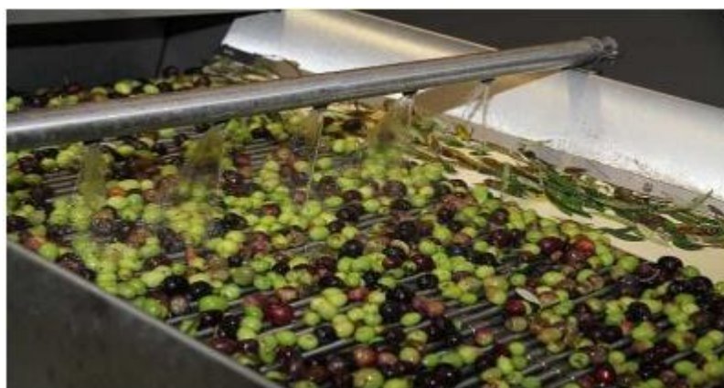
Figure 7 : le passage des olives par l'effeuillage et lavage ( site 3 )
